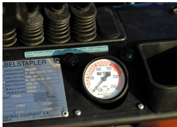
optische Anzeige und Manometer in Armaturenbrett
