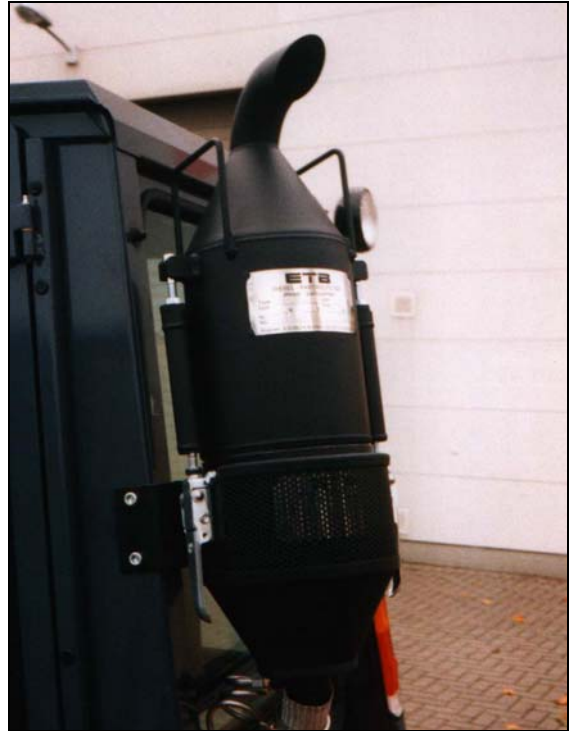
Montagebeispiel EWR 30, Sonderausführung für Installation am Kabinenrahmen
