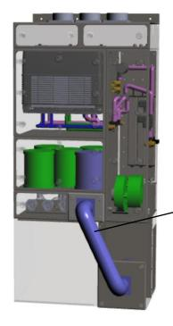
Bypass Draußen – bestehend aus 2x Deckel und Schlauch
