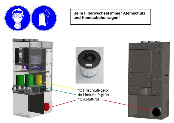
Zum Wechsel der Umluft und Frischluftfilter muss der entsprechende Deckel mittels Dreikantschlüssel entfernt werden. Die Filter besitzen einen Bajonettverschluss – können durch leichtes Drehen gelöst und wieder befestigt werden.
