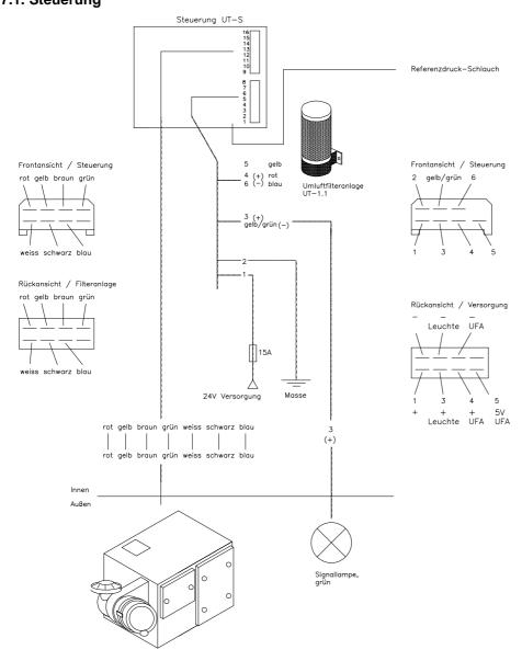
Kabel - links / Filteranlage Kabel - rechts / Versorgung Steckplatz Kabel **Funktion** Steckplatz Kabel Funktion Stromversorgung-S/A ge/gr 9 braun 1 - Leuchte 2 10 schwarz Masse 3 + Leuchte Kontaktstrom-A 3 - UFA 11 grün 6 Kontaktstrom-S 4 + UFA 12 weiss 4 PWM - Signal 5 Kontaktstrom-UFA 13 blau Gebläse; 50% 6 5 5 Volt, UFA 14 gelb Gebläse; 100% 7 2 - Masseversorgung 15 rot Druckluftventil (Option) + Stromversorgung 16 8
