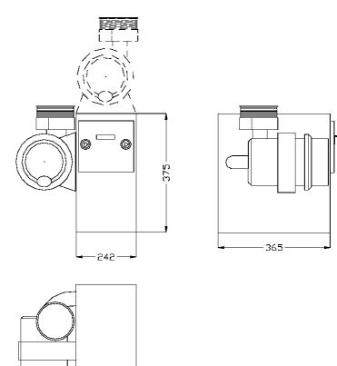
Abmessungen (LxBxH) – mm :  $242 \times 365 \times 375$ Gewicht ohne Filter – kg : ca. 15
