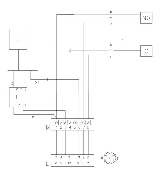
J = Gebläse UT L = Anschlußkabel M = Klemmleiste UT
