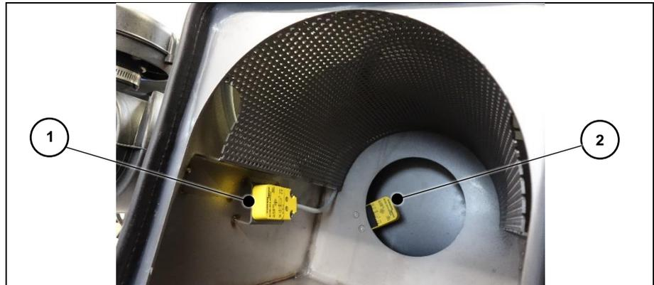
Abbildung 4: Näherungsschalter
