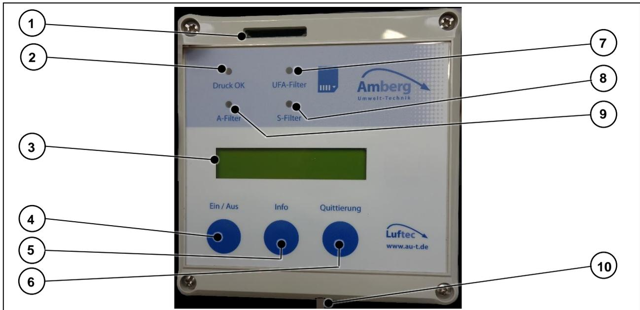
Abbildung 11: Übersicht Bedienpanel
