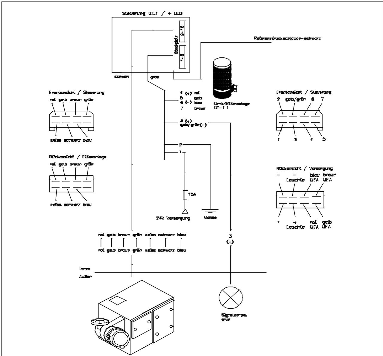
Abbildung 16: Steuerung der Schutzbelüftungsanlage
