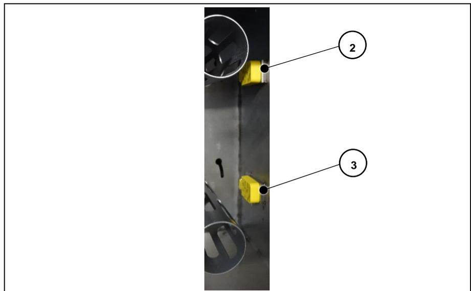
Abbildung 5: Näherungsschalter Gasfilter
