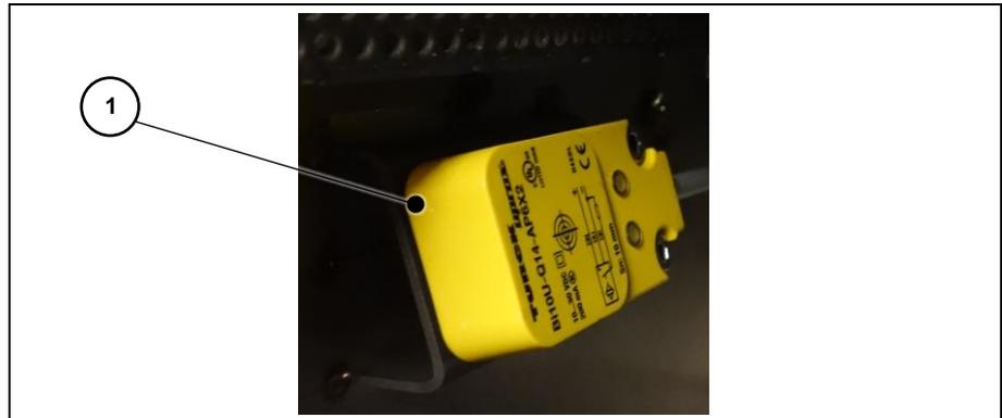
Abbildung 4: Näherungsschalter Partikelfilter
