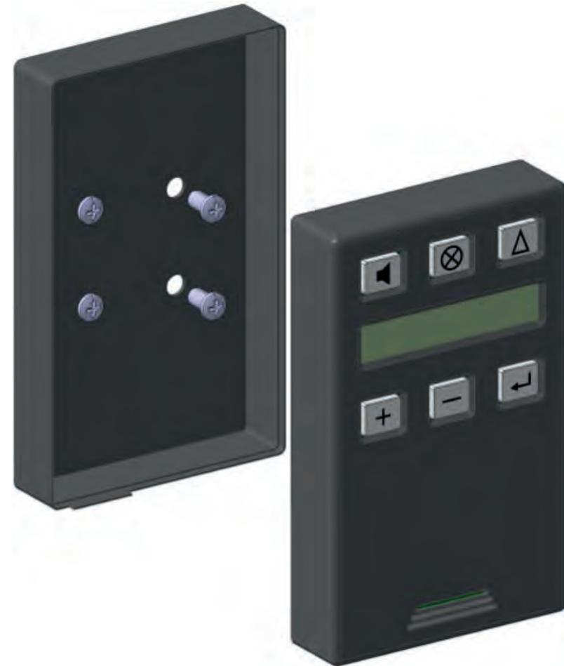
Das Display wird an einer gut sichtbaren Stelle im Führerhaus montiert. Dazu wird der rückwandige Deckel des Displays mittels Schrauben oder Nieten am Fahrerhaus montiert. Die Vorderseite mit Elektronik wird vorsichtig aufgesteckt, bis sie einrastet. Achtung: Das Display ist nicht wasserdicht!
